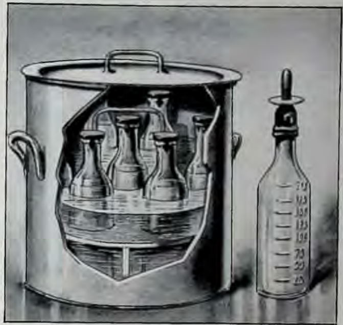
Fig. 17. — APPAREIL DE SOXHLET. On voit ici la marmite de fer-blanc dont un morceau de paroi a été enlevé pour montrer, dans le « panier » de fil de fer, les biberons munis de leurs obturateurs de caoutchouc et plongés dans l'eau que l'on fera bouillir. — A droite: un biberon dont l'obturateur a été enlevé et remplacé par une tétine. (D r Wagner del.)
