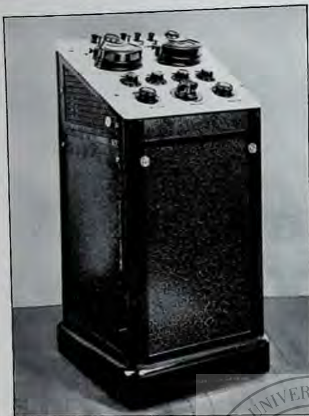
Fig. 25. — APPAREIL DE DIATHERMIE POUR LA D'AR- SONVALISATION. On donne ainsi, selon les distances et le réglage, effluves, étincelles, chaleur, destruction. (Cl. Gaiffe- Gallot et Pilon.)
