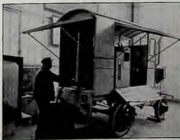
Fig. 8. — STÉRILISATION DE L'EAU. La stérilisation de l'eau par l'ozone permet l'utilisation de postes ambulants comme celui-ci. (Cl. Boyer.)
