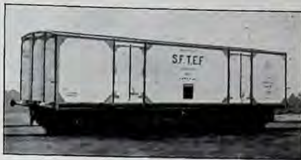
Fig. 4. — UN WAGON FRIGORIFIQUE. Le transport des substances alimentaires altérables se fait avec une grande sécurité dans les wagons frigorifiques dont nous représentons ici un type en service sur la Compagnie des Chemins de fer du Nord.
