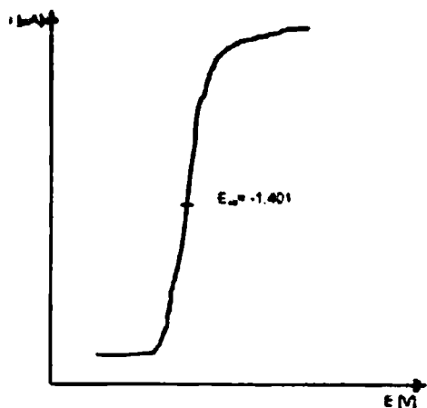
2 ábra. A 2-(a-hidroxi-4-dimetilamino-benzil)-ciklohexanon polarogramja. Alapoldat: 0,1 M \text{NH}_4\text{Cl} 75 %-os etanol-víz keverékoldószerben. C = 1 \text{ mM} .
